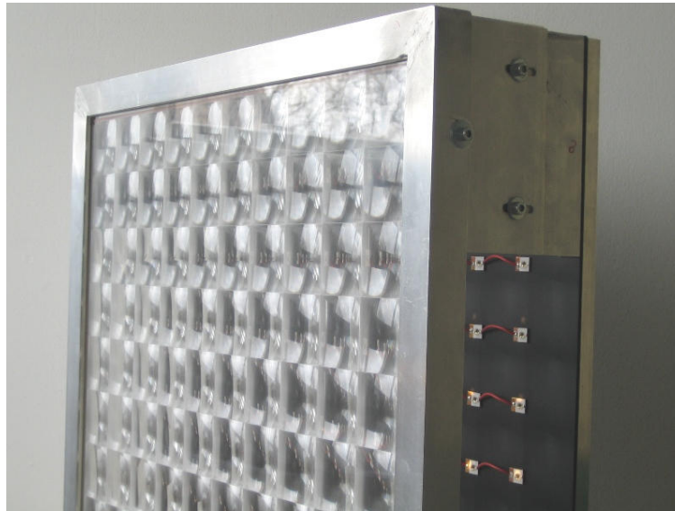
Obr. 2 – Solární panel s celkovou plochou 0,25m 2 vyvinutý v Elceram
